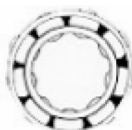
Недостаток смазки Усиление амплитуды сигнала
