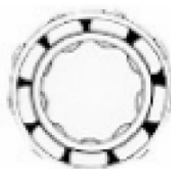
Недостаток смазки Усиление амплитуды сигнала
