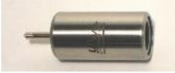
Este módulo é utilizado para receber ultrassons de transmissão aérea como os ultrassons emitidos por fugas de pressão/fugas em vácuo e descargas elétricas. Existe uma ficha macho na parte de trás do módulo. Para o posicionamento, alinhe a ficha com o recetáculo correspondente na parte da frente do invólucro da pistola e ligue. O Módulo de Rastreo tem um transdutor piezoelétrico para escolher o ultrassom de transmissão aérea.
