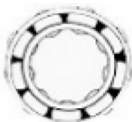
A falta de lubrificação aumenta os níveis de amplitude
