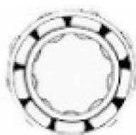
Nedostatek maziva zvyšuje Amplitudu
