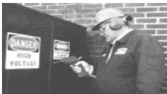
Testujte rozvaděče, transformátory, atd. na oblouky, povrchové výboje a korony.
