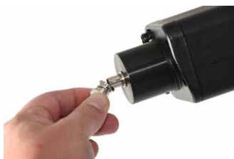
Passo 3 - Ligue o seu Ultraprobe à Caixa Comutadora
