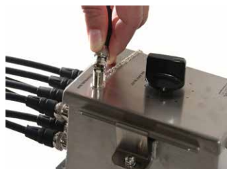
Passo 2 - Ligue os sensores à Caixa Comutadora
