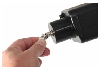
Krok 3 - Připojte Ultraprobe k přepínači
