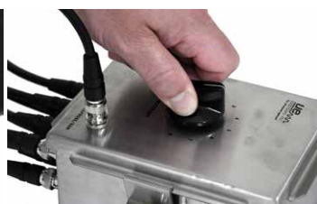
Krok 4 - Přepínejte jednotlivé body a odečítejte naměřené hodnoty
