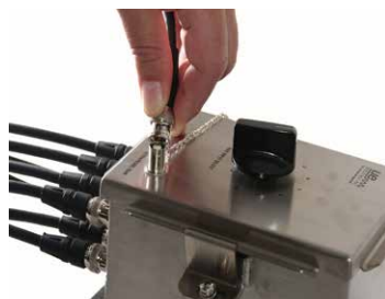
Krok 2 - Připojte snímače k přepínači
