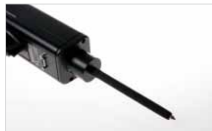
STETHOSCOOPMODULE met puntvormige geluidsgolfgeleiding
